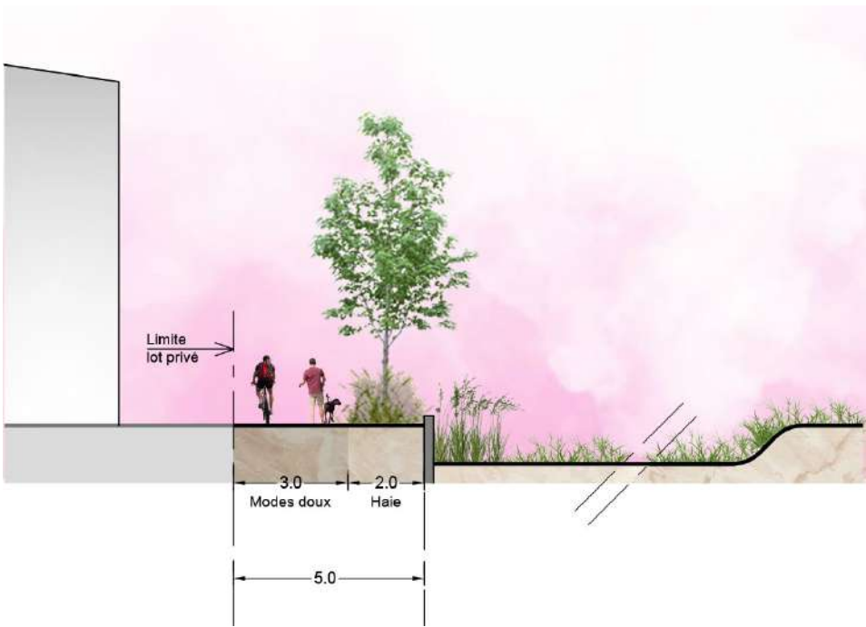
Profil bordant le bassin de rétention
